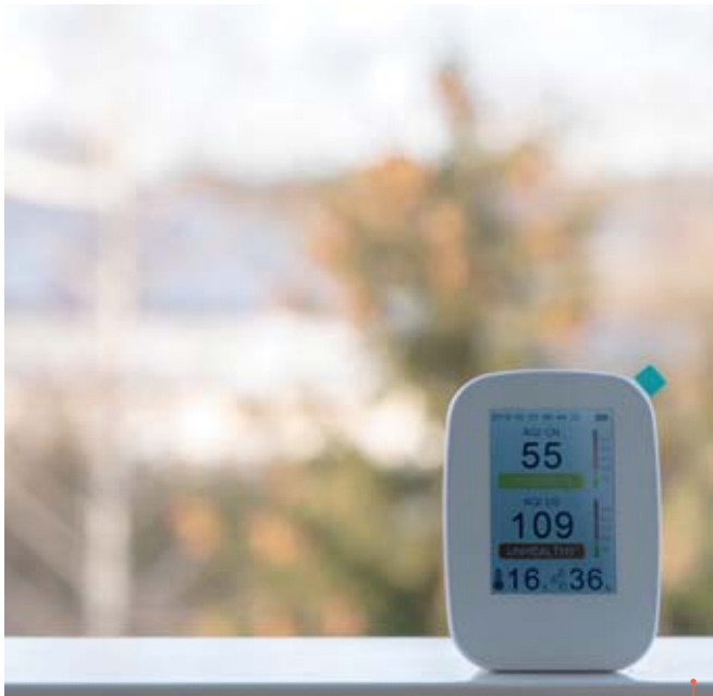
Capteur de mesure en continu de certaines familles de polluants de l'air intérieur
