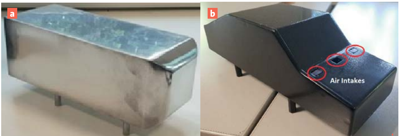
Figure 3 : Maquettes de voitures utilisées pour étudier les infiltrations : (a) corps d'Ahmed, (b) maquette MIRA © Amine Mehel
