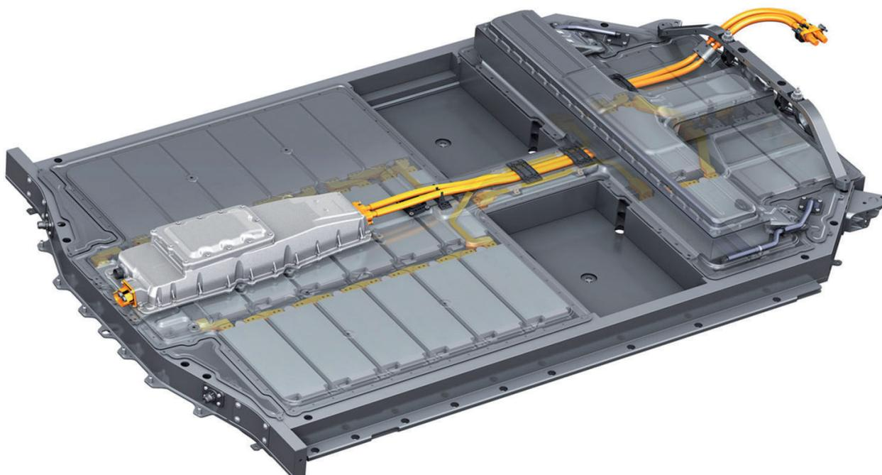
Composition d'une batterie de véhicule électrique - ©Veolia
