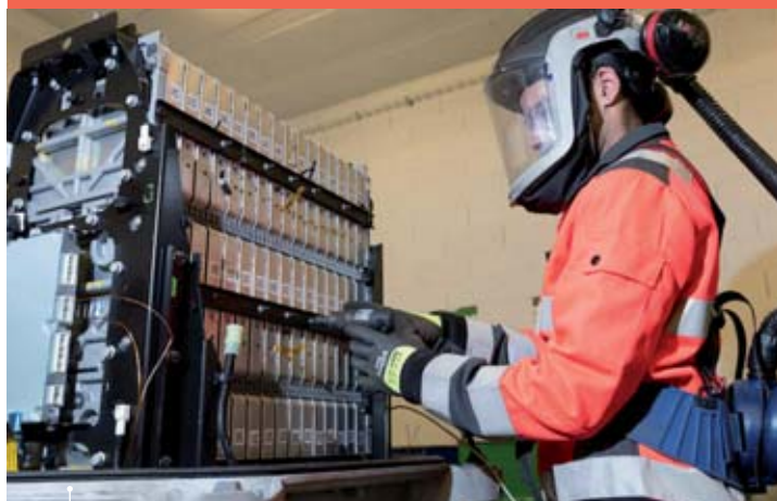
Démantèlement d'une batterie - ©Veolia
