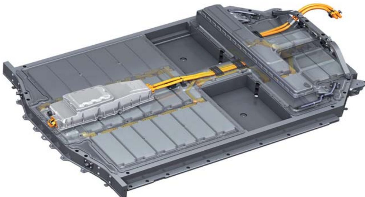
Composition d'une batterie de véhicule électrique - ©Veolia
