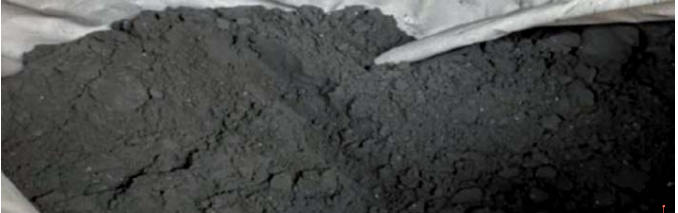
« Black mass » extraite du broyage des cellules de batteries, contenant principalement un mélange de carbone, nickel, lithium et cobalt. - ©Veolia
